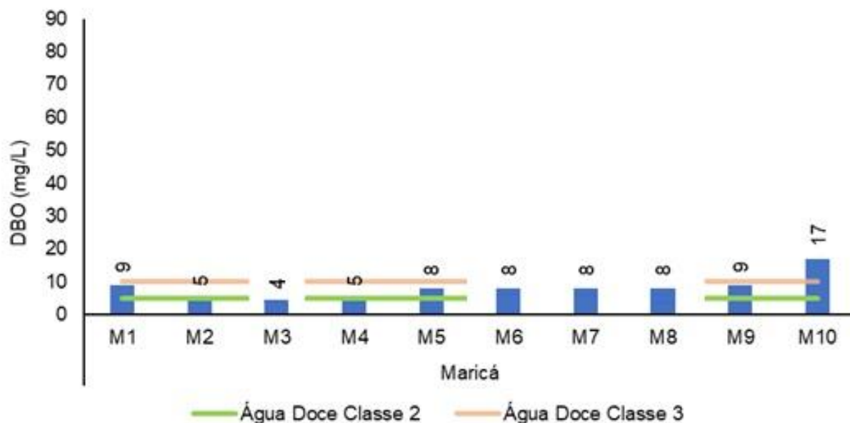
Figura V-8. Distribuição de DBO na Sub-bacia do Sistema Lagunar de Maricá durante a campanha de julho de 2025.
