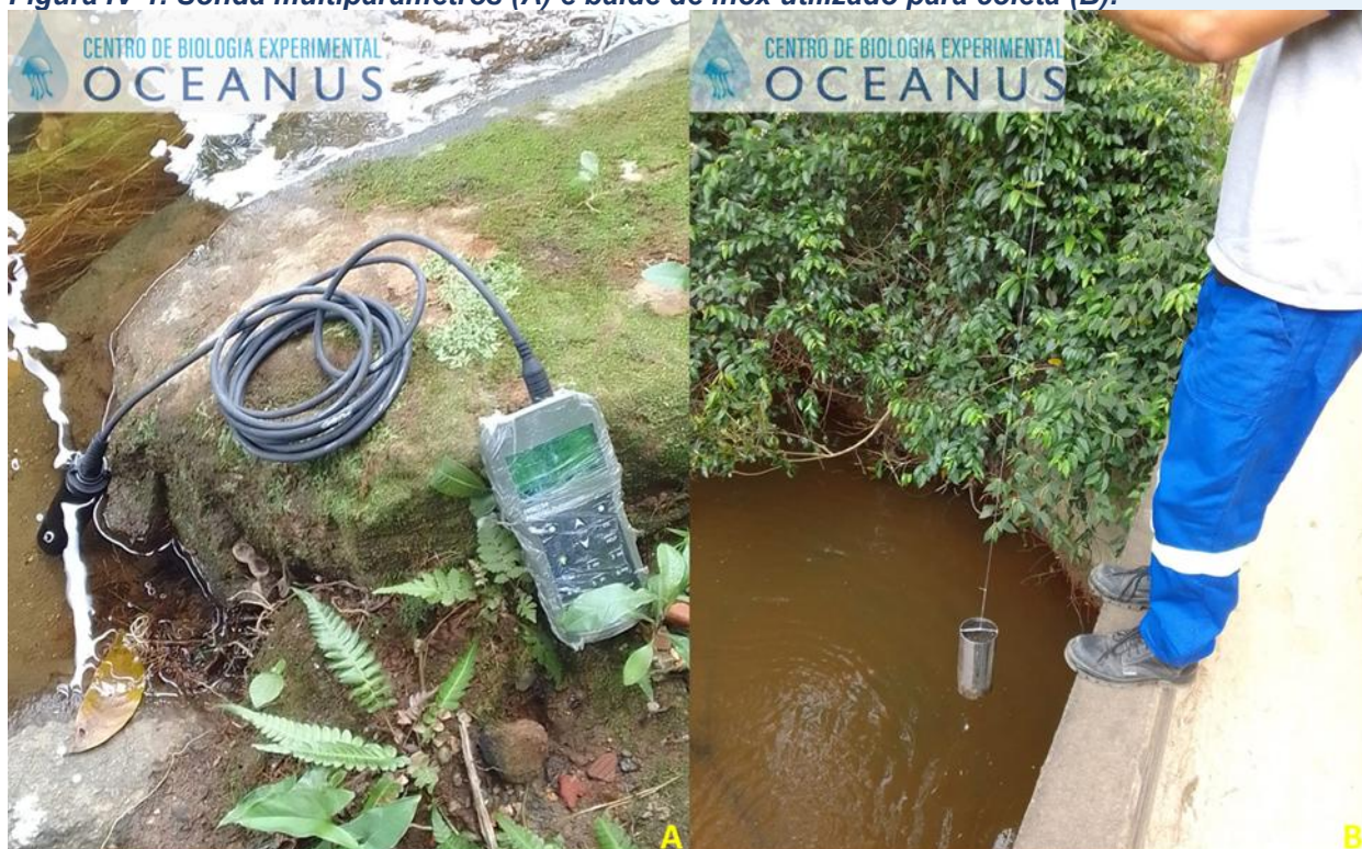
Figura IV-1. Sonda multiparâmetros (A) e balde de inox utilizado para coleta (B).
