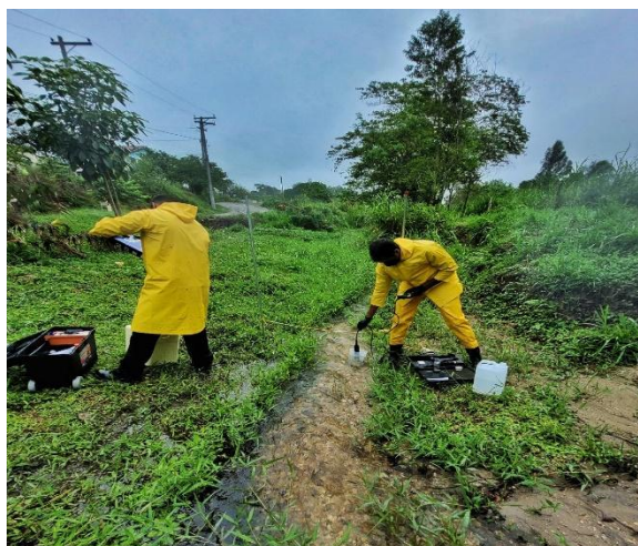
Figura 17: Coleta de amostra de água no Rio Silvado (Maricá) para análise de parâmetros do IQA através de sonda multiparamétrica.
