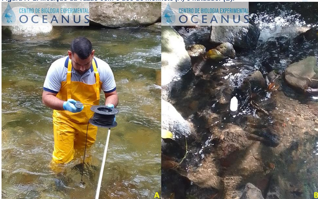
Figura IV-2. Medição da vazão com o uso de molinete (A) e flutuador (B).
