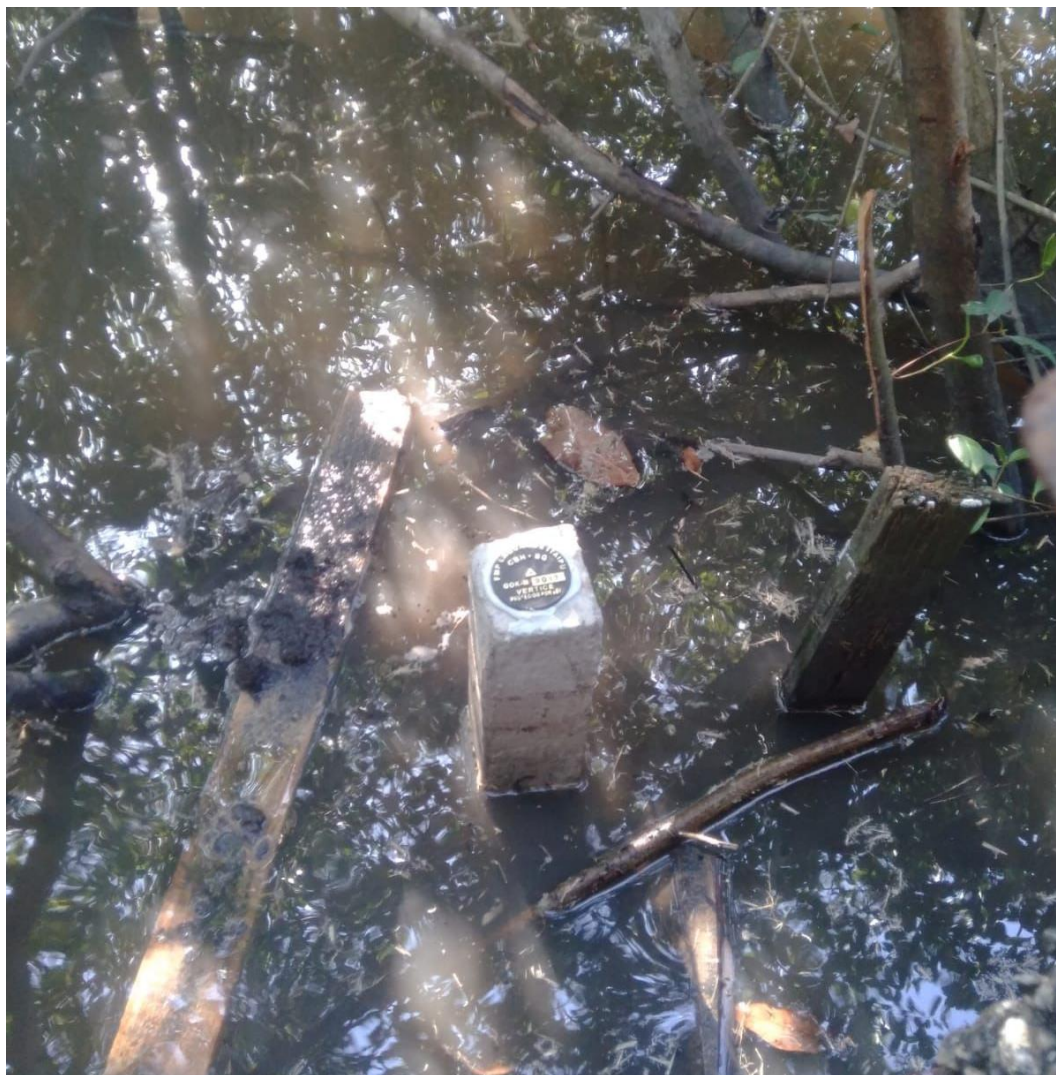
Figura 06: Marco de concreto de 1m
