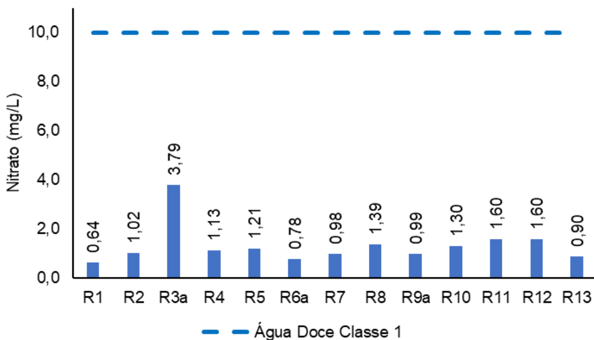
Figura V.2.1-33. Distribuição de nitrato na Bacia da Lagoa Rodrigo de Freitas durante a campanha de fevereiro de 2024.
