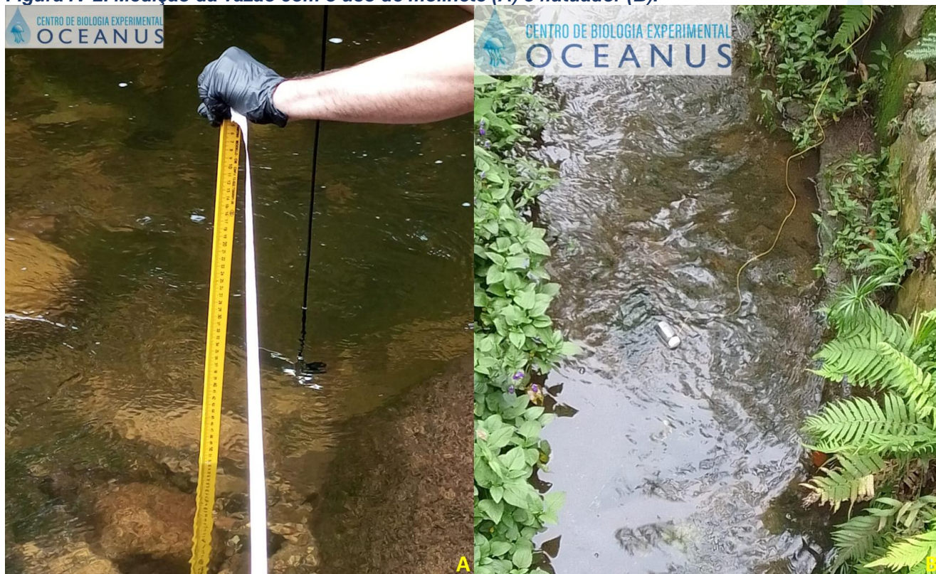
Figura IV-2. Medição da vazão com o uso de molinete (A) e flutuador (B).
