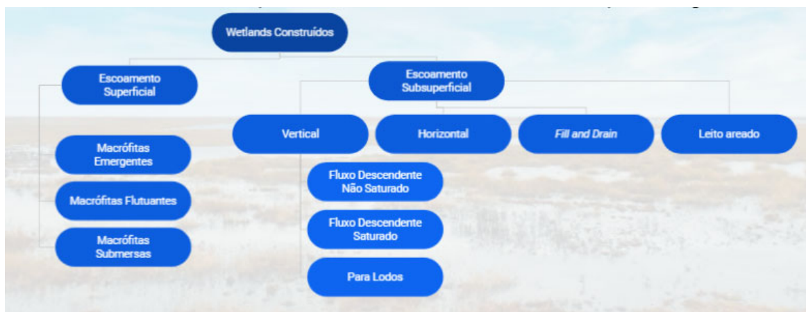
Figura 30: Classificação dos Wetlands Construídos Fonte: CRISTIANE RUBIM, Revista TAE, 2017
