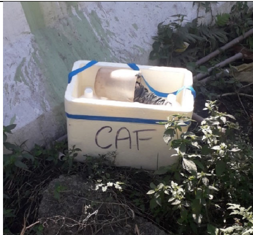
Kit de coleta preparado previamente, com os recipientes designados por ponto de coleta e parâmetro
