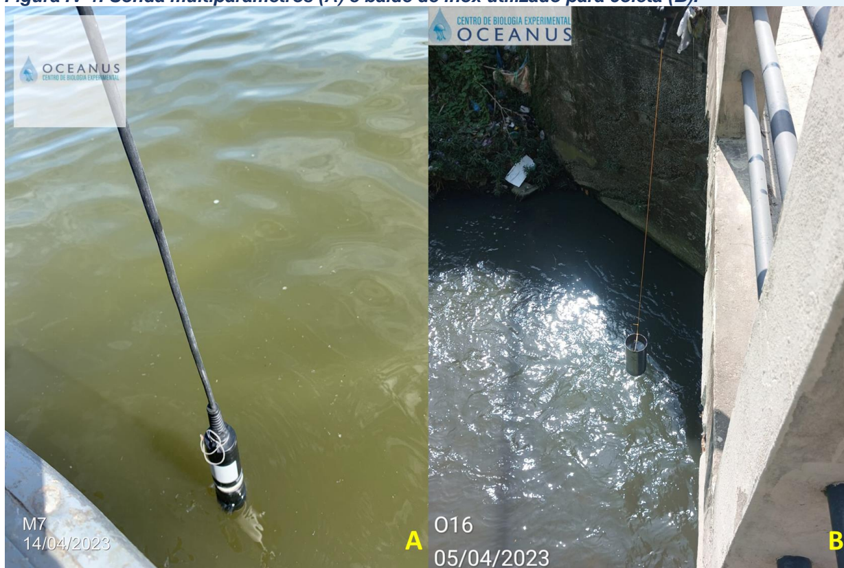
Figura IV-1. Sonda multiparâmetros (A) e balde de inox utilizado para coleta (B).
